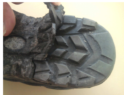
Photo n°4 : Décollement d'une couche de la semelle au niveau du talon
