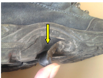
Photo n°5 : Décollement d'une couche de la semelle au niveau de la voûte plantaire
