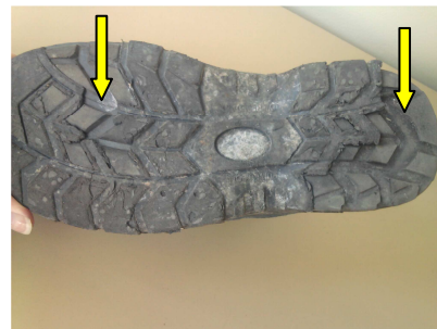
Photo n°2 : Décollement d'une couche de la semelle
