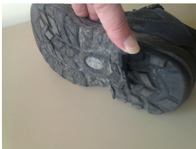
Photo n°3 : Décollement d'une couche de la semelle au niveau du talon
